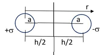
$$V(r)_{+\sigma} = - \frac{\sigma a}{\epsilon_0} \ln r + c_1 \quad ; \quad V(r)_{-\sigma} = \frac{\sigma a}{\epsilon_0} \ln(h - r) + c_2 \quad ; \quad \text{da cui: } V(r) = V(r)_{+\sigma} + V(r)_{-\sigma} = \frac{\sigma a}{\epsilon_0} \ln \frac{h-r}{r} + c_1 + c_2$$
